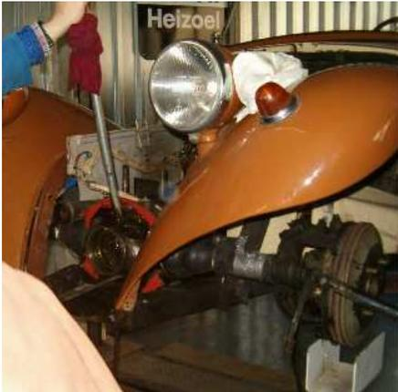
der Zahnstange entfernt. Nachdem das Differential mit den beiden Halbachsen vorgezogen war, konnte der gesamte Käfig mit dem Tellerrad herausgehoben und gereinigt werden. Da trotz genauer Untersuchung keine eklatanten Beschädigungen oder Verschleiß der Zahnräder erkennbar war, entschloss man sich auch das Ritzel des direkten Eingriffs auszubauen. Dies nahmen wir uns für den nächsten Tag vor.
