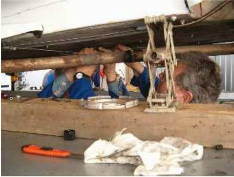
bremsszylinder ausgebaut werden. Dies war auch nötig, da die Kolben nicht mehr leichtgängig und die Dichtungen porös und verschlissen waren. Die Innenfläche der Bremszylinder wurde gereinigt, geschliffen und poliert und die Kolben konnten mit den neuen Dichtungen eingesetzt werden. Gut dass Heinz noch ein paar Dichtungen vorrätig hatte
