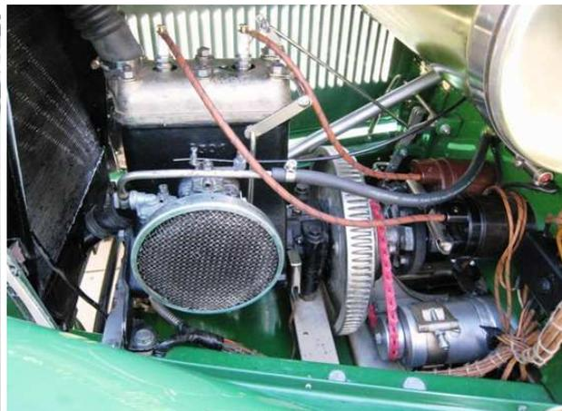
Abb. 13 a+b: Aero 18 ab 1931 mit 662 cm<sup>3</sup> 2-Zylinder Zweitakter - Hinterradantrieb
