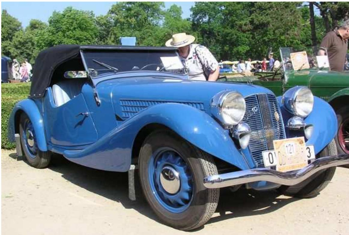
Abb. 23a: Aero 50 ab 1936 mit 2000 cm<sup>3</sup> 4-Zylinder Zweitakter mit 50 PS und Vorderradantrieb
