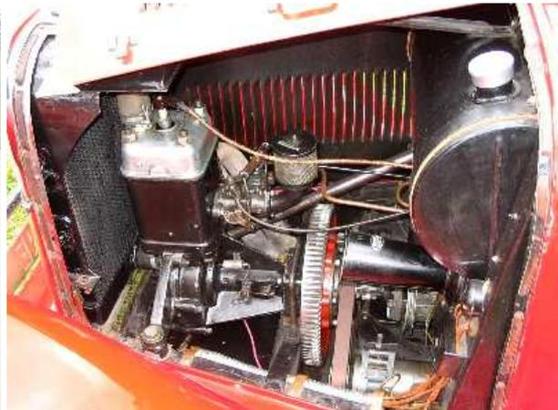
Abb. 12a+b: Aero 10 ab 1929 mit 500 cm<sup>3</sup> 1-Zylinder Zweitakter – Hinterradantrieb
