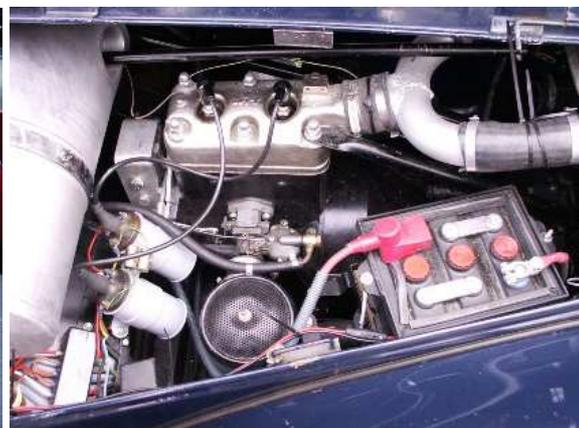
Abb. 20a+b: Aero 30 Roadster, Modell 1936 mit 1000 cm<sup>3</sup> 2-Zylinder Zweitakter – Vorderradantrieb
